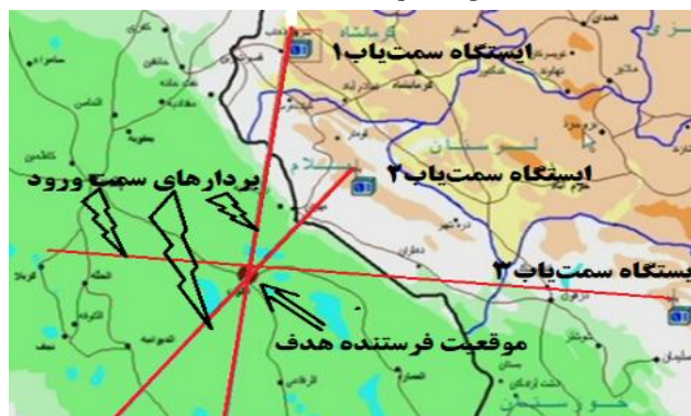
شکل شماره ۵: مکان‌یابی یک فرستنده فرضی با استفاده از روش مثلث‌بندی.
