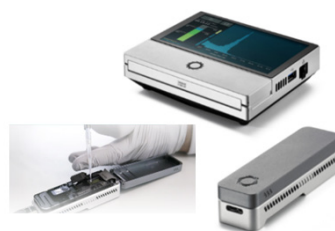
شکل ۳- دستگاه MinION. توالی‌یاب پرتابل ساخت شرکت Oxford Nanopore Technologies کشور انگلستان این دستگاه قابل حمل بوده و وزن آن ۴۵۰ گرم می‌باشد و برای خوانش توالی‌های DNA یا RNA از سائز بسیار کوچک تا بیش از 4 Mb می‌باشد.
